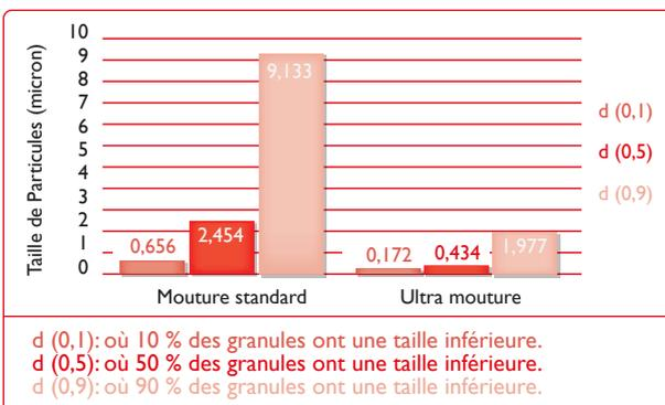
L'Ultra mouture peut produire jusqu'à **180 fois davantage de particules** à partir de la même quantité de matière active. La **surface de contact** augmente jusqu'à **32 fois**. Cela augmente l'efficacité ou permet d'utiliser des doses inférieures.
